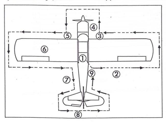
FIGURE 3 - 1 PREFLIGHT INSPECTION
