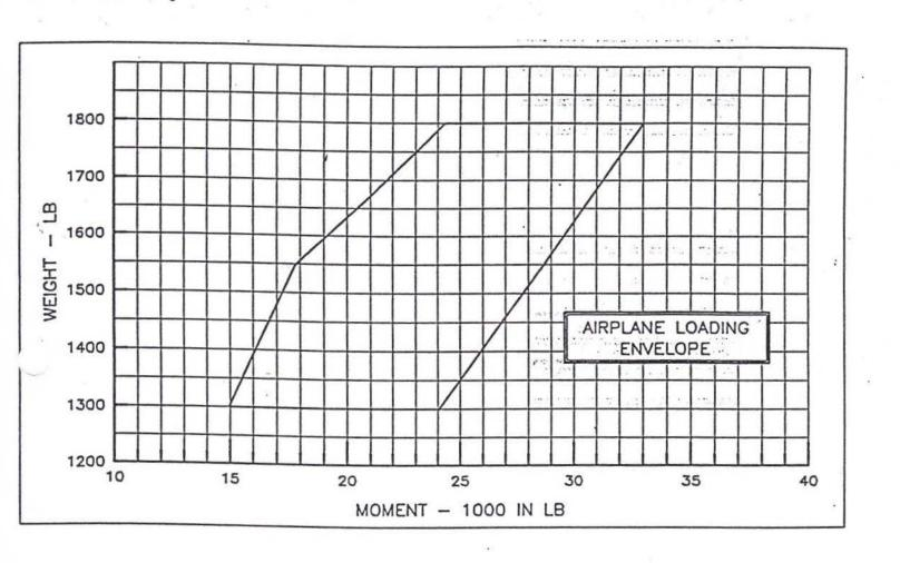
FIGURE 5-3 SUPER DECATHLON WEIGHT and BALANCE FLIGHT ENVELOPE
