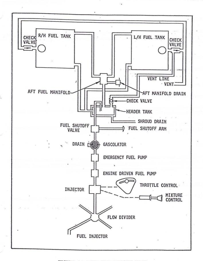
FIGURE 6-2 FUEL SYSTEM SCHEMATIC
